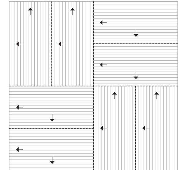
Sul retro delle piastrelle, impresso nella marca, sono presenti due frecce che orienteranno la posa.
